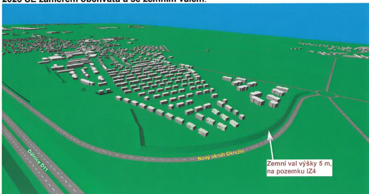
Obr.6-1B: 3D pohled výpočetního modelu od jihovýchodní strany s novou zástavbou, Výhled 2025 SE záměrem obchvatu a se zemním valem.
