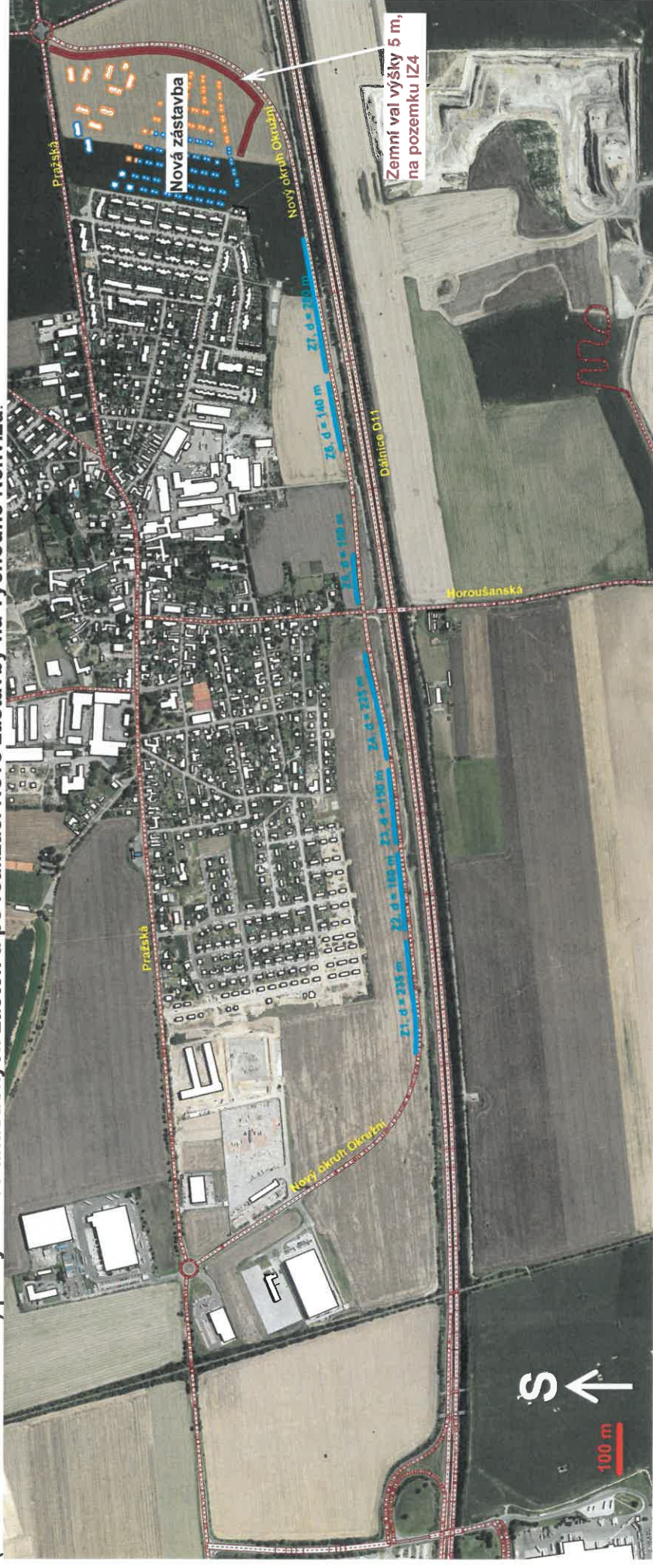
Obr. 6-1A: Situace minimálního rozsahu akustických zástěn kolem obchvatu Nehvizd, ozn. Z1 až Z7, varianta výpočtu: Výhled 2025 aktivní – se záměrem (s obchvatem Nehvizd) po výstavbě akustických zástěn a po realizaci Nové zástavby na východně Nehvizd.
